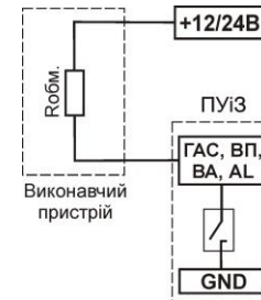
Рисунок А.6 – Загальна схема підключення виходів типу «відкритий колектор»
