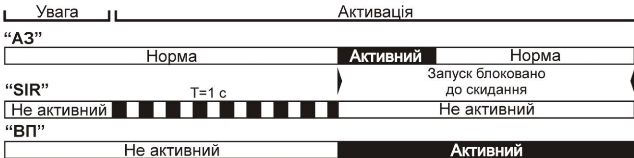
Рисунок 4.6 – Алгоритм «Аварійне зупинення» (вхід «А3»)
