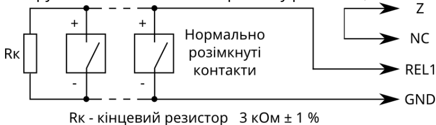
Рисунок 2.9 – Схема підключення двопровідних датчиків з нормально розімкнутими контактами
