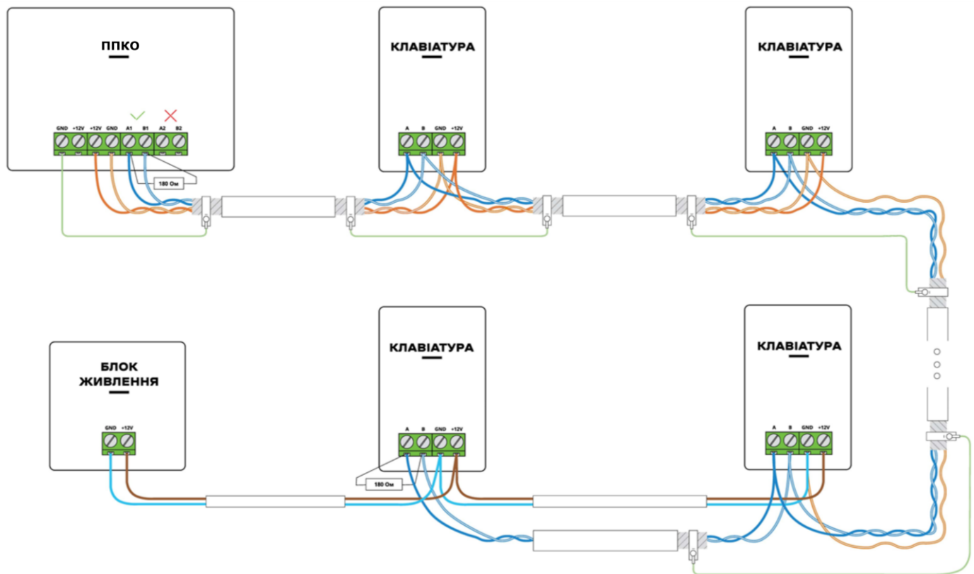
Рисунок 2.3 – Приклад підключення клавіатур (варіант ППКО на початку лінії обміну)
