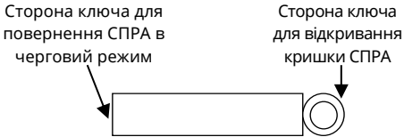
Рисунок 6.2 – Ключ для обслуговування СПРА
