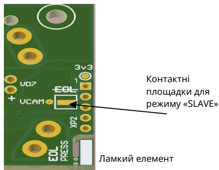
Рисунок 4.4 – Розміщення ламкого елемента та контактних площадок для режиму «SLAVE» на платі
