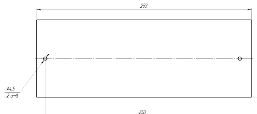
Рисунок 2.1 – Розмітка отворів на основі корпусу оповіщувачів
