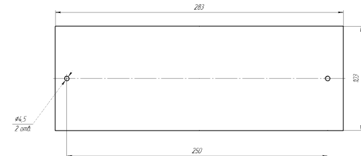
Рисунок 4 – Розмітка отворів на основі корпусу оповішувачів
