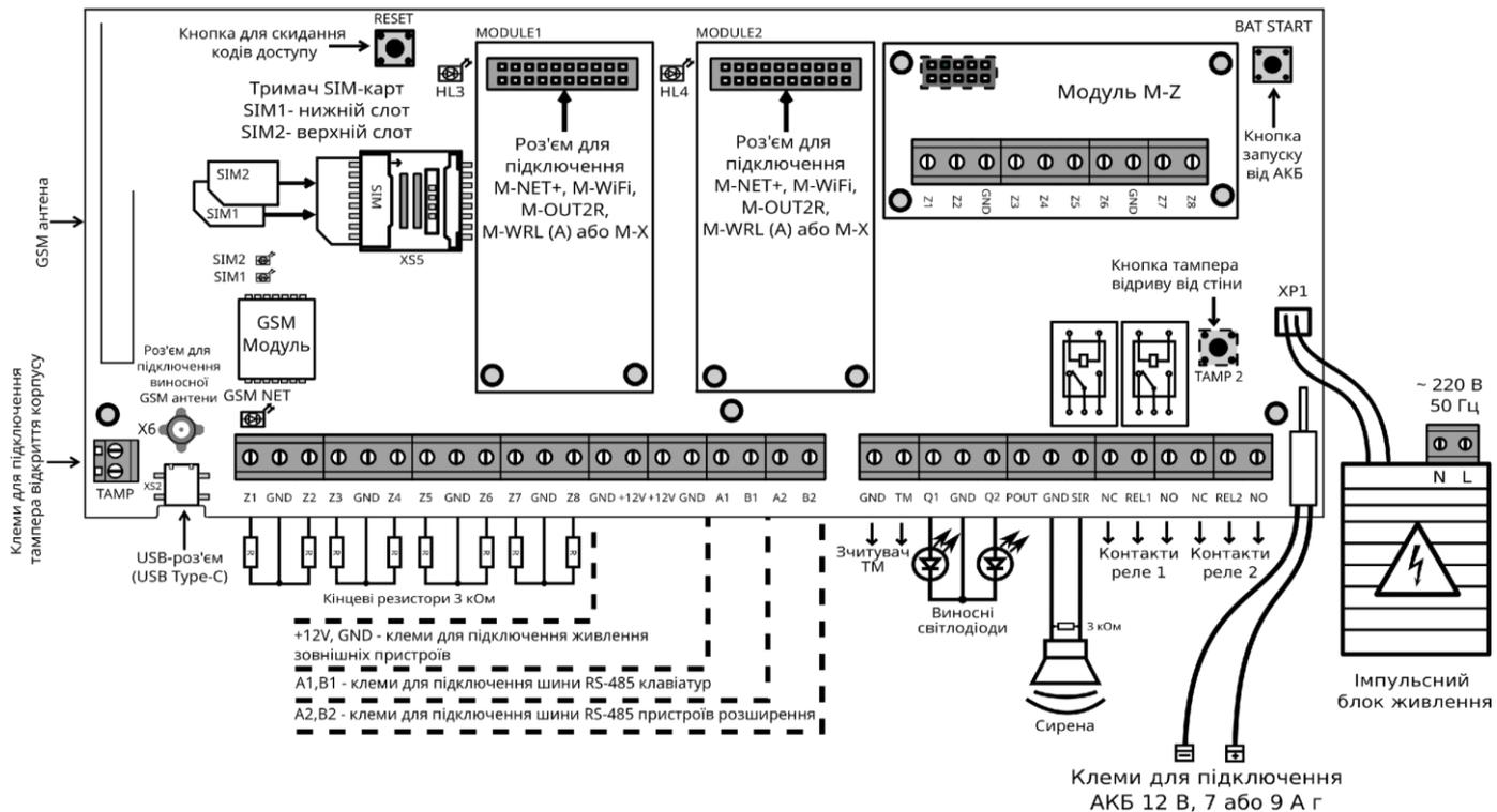
Рисунок А.1 – Схема електрична підключення ППК Orion NOVA L/L(i) HW3
