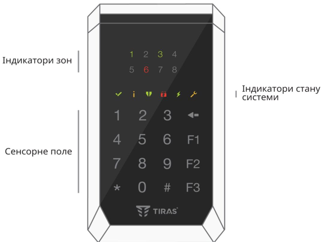
Рисунок 5.5 – Клавіатура K-PAD8/X-PAD
