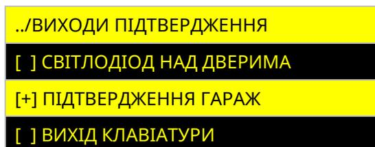
Рисунок 4.4 – Вікно вибору виходів підтвердження для групи
