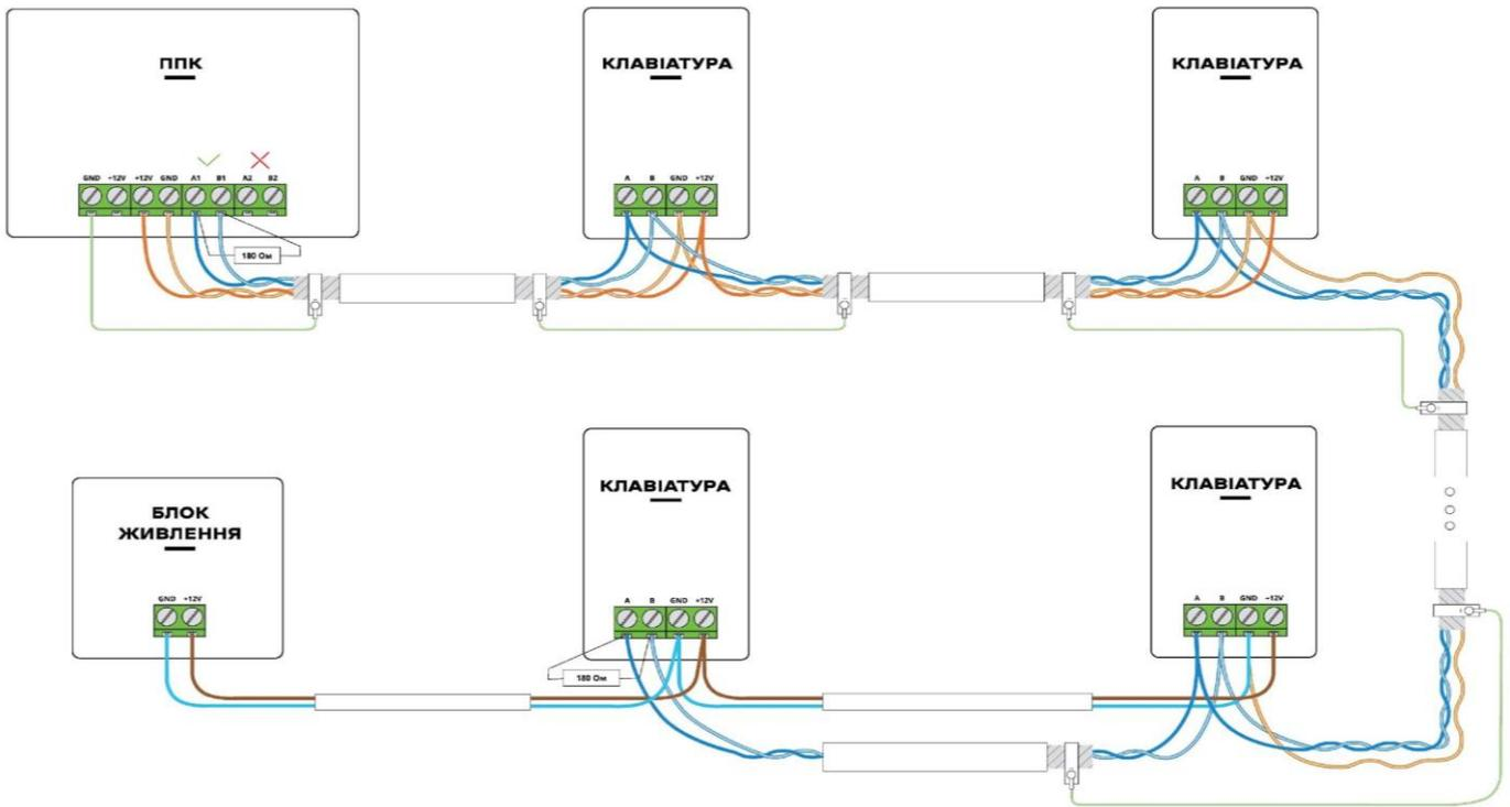
Рисунок 2.3 – Приклад підключення клавіатур (варіант ППК на початку лінії обміну)
