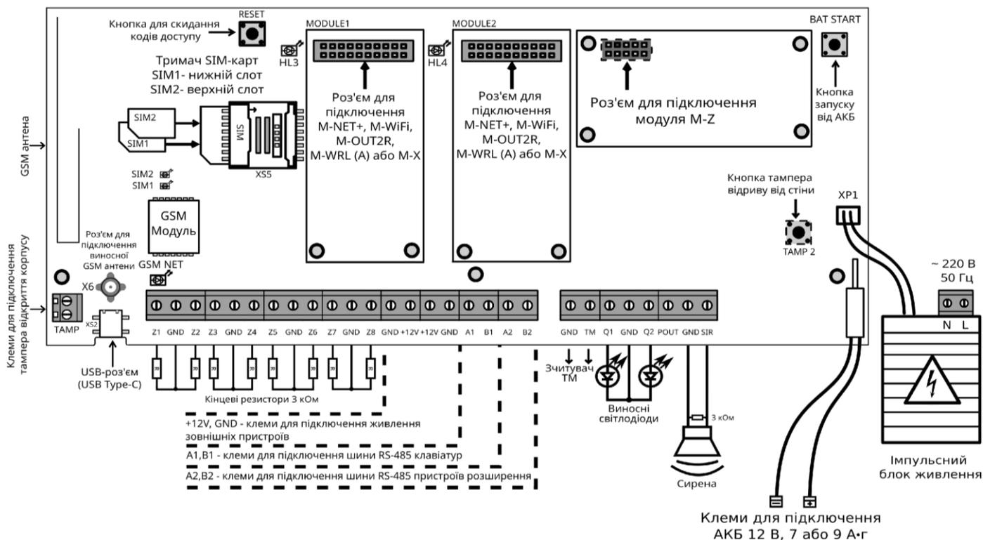
Рисунок А.2 – Схема електрична підключення ППК Orion NOVA M/M(i) HW3
