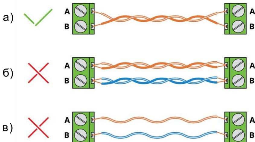
Рисунок 2.2 – Приклад підключення шини інтерфейсу RS-485
