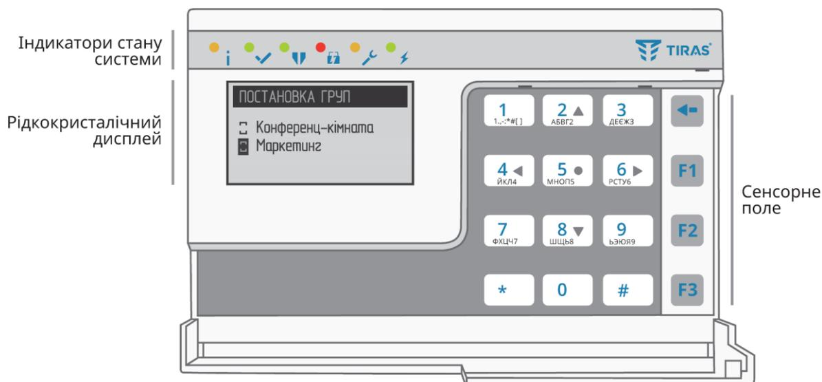
Рисунок 5.1 – Клавіатура K-LCD
