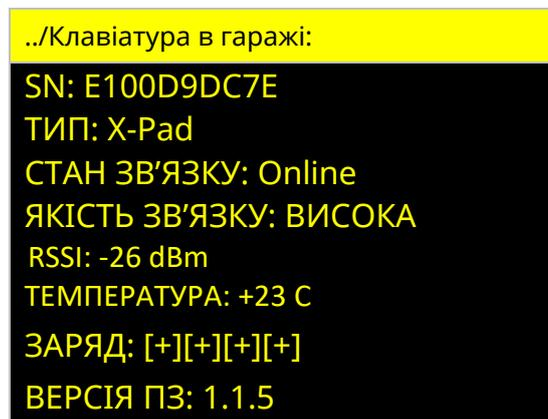
Рисунок 4.13 – Вікно перегляду стану бездротового пристрою
