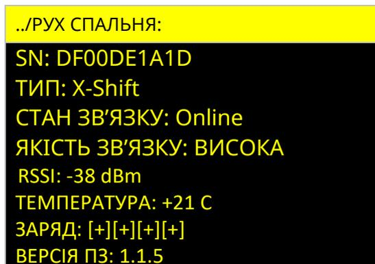
Рисунок 4.9 – Вікно перегляду стану бездротового пристрою
