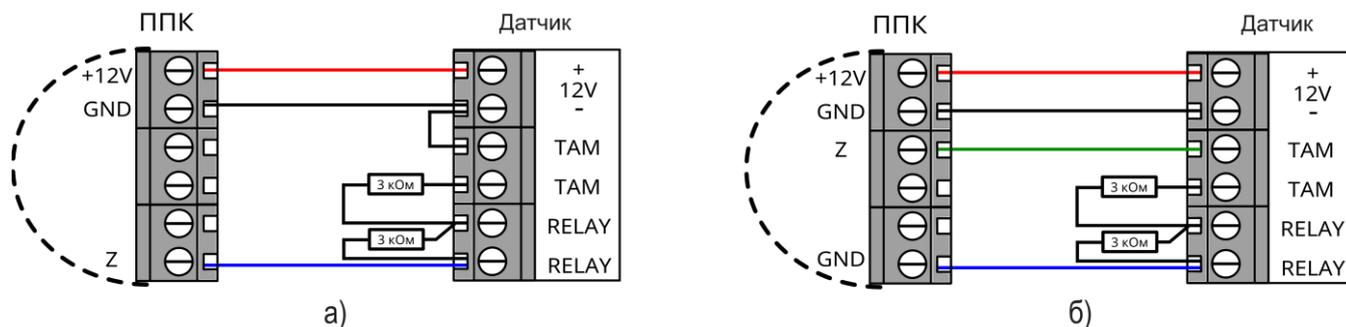
Рисунок 2.8 – Приклади підключення датчиків по типу 2EOL
