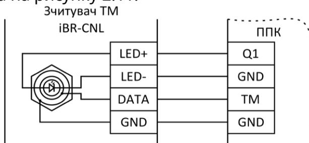
Рисунок 2.11 – Схема підключення зчитувача ключів ТМ
